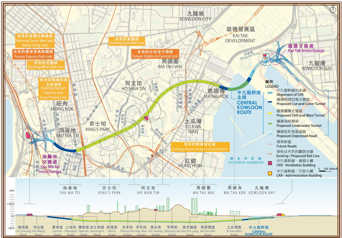
圖一：中九龍幹線平面圖及縱剖面
