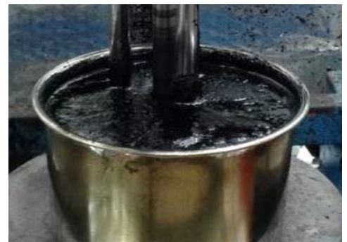
在實驗室內的碎橡膠改性瀝青
