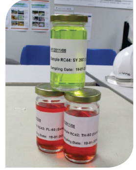
檢測柴油燃料的質素，確保硫磺含量沒有超標
