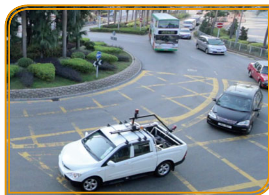
採集道路設施資料只需動用一輛配備移動道路測量系統的車輛
