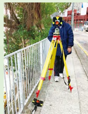
進行監察測量以追蹤樹木的位移情況
