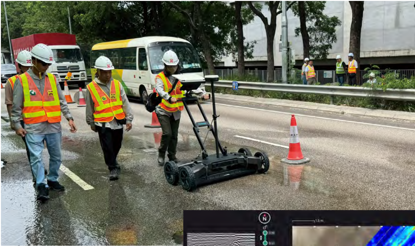
使用探地雷達測量行車道 GPR surveying a carriageway
