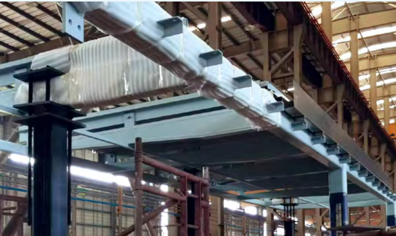
「7」字形預製組件 "7"-shaped pre-fabricated modules
