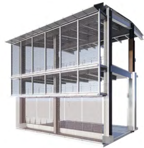
設有遮雨簷篷系統的網狀外牆系統 Mesh façade system with rain canopy system
