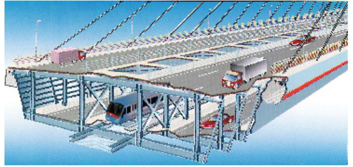
而成，每條鋼束由7條直徑15.7毫米的鍍鋅鋼絲組成，外層包膠，並注入軟脂保護。斜拉索再由重型的膠層外套保護。
