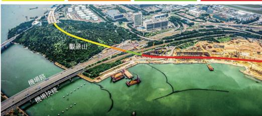
這是首次於香港採用箱涵頂進方法建造行車隧道，以便維持機場快線正常及安全運作。箱涵隧道構件的推進仿照毛蟲的動態，以19,400噸設計起重力順序推進；此力量足以一次過提起70架空載的A380空中巴士。(最大的箱涵構件約闊23.5米、高14米、重5,000公噸，相當於188輛雙層巴士的重量)。
