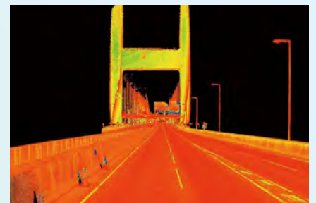
在青馬大橋擷取的 3D LIDAR 數據
