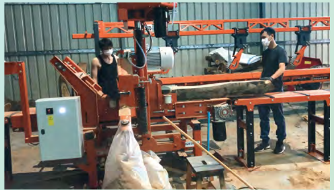
使用鋸木機切割木材
