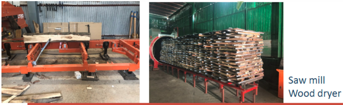
木材升級再造的過程及所需的設備
