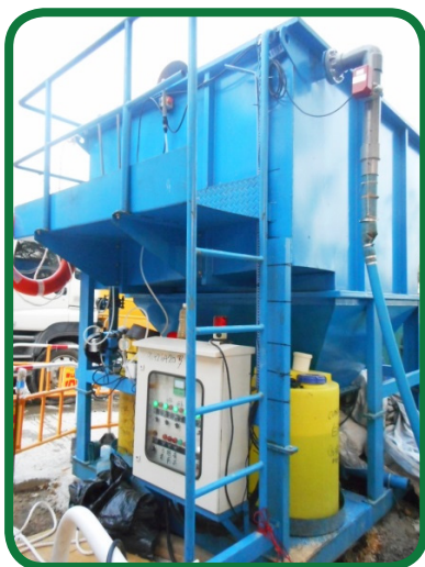
廢水管理 - 在工地的廢水處理裝置
