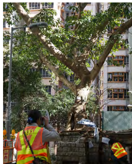
■ 利用全站儀運用投射法測量石牆樹測點座標
