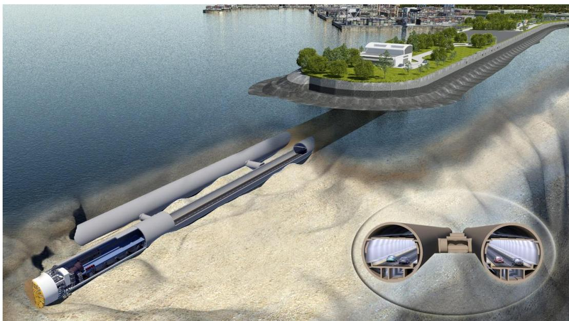
香港第一條以隧道鑽挖機在海底興建的行車隧道
