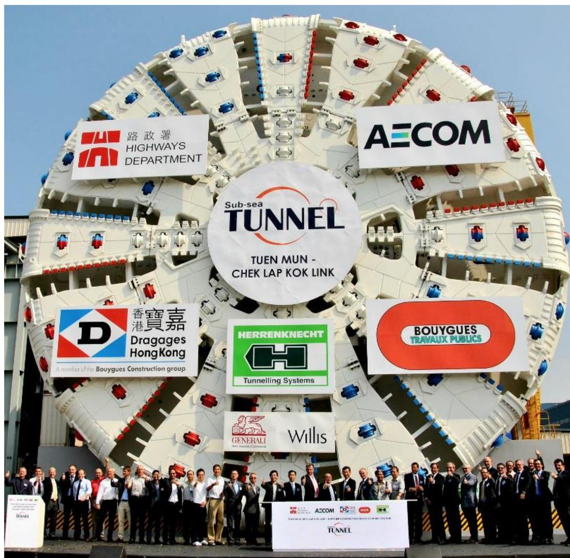
直徑 17.6 米隧道鑽挖機
