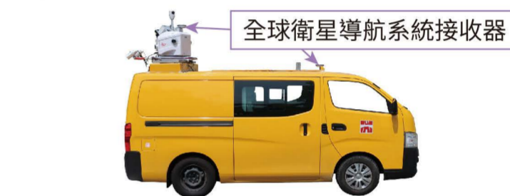
移動激光掃描及影像系統搭載於測量車上
