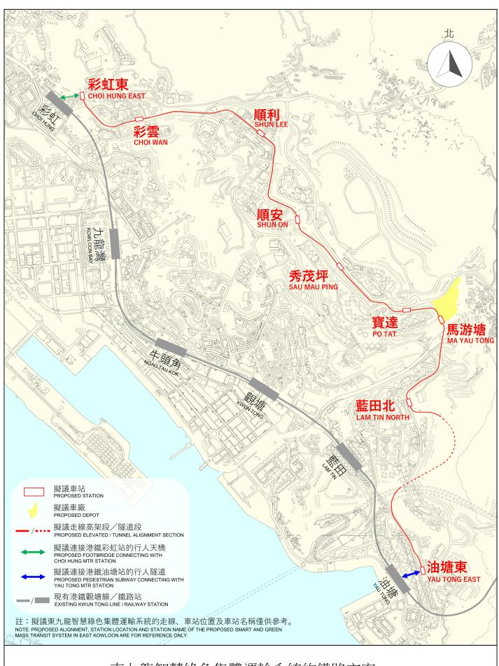
東九龍智慧綠色集體運輸系統的鐵路方案 PROPOSED RAILWAY SCHEME FOR SMART AND GREEN MASS TRANSIT SYSTEM IN EAST KOWLOON
